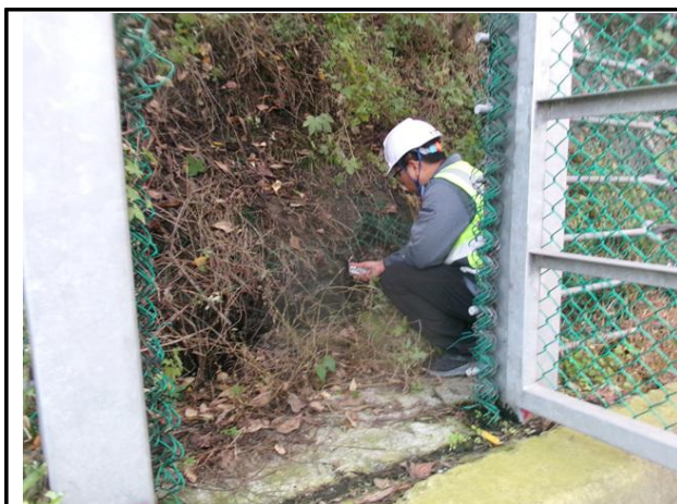
절리면 경사/경사방향 측정
